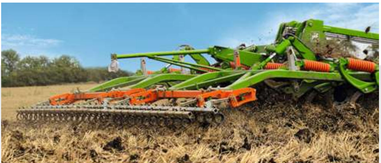
Doppelstriegel bei der flachen Bearbeitung
