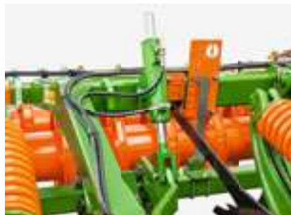
Zylinder zur Tiefeneinstellung der Einebnungseinheit
