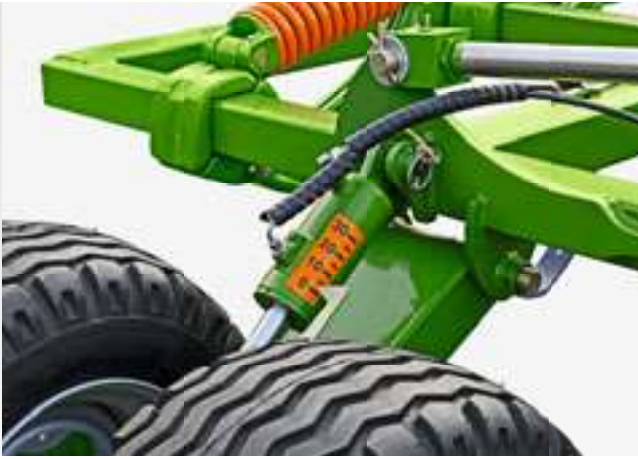
Skala der hydraulischen Arbeitstiefenverstellung des Zinkenfeldes
