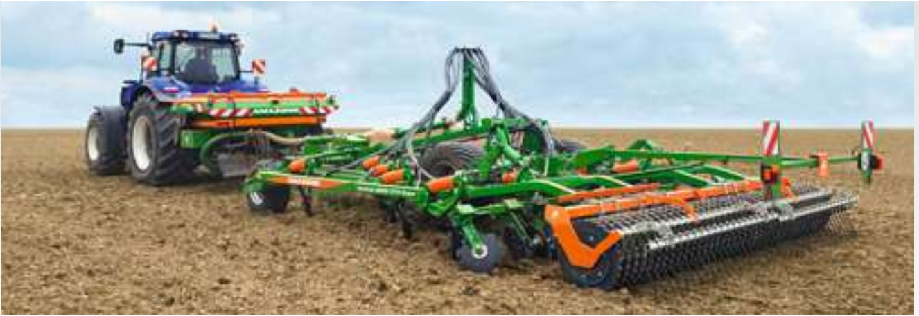
XTender 2200 mit Cenius 5003-2TX und einer Förderstrecke zur Ausbringung von Dünger
