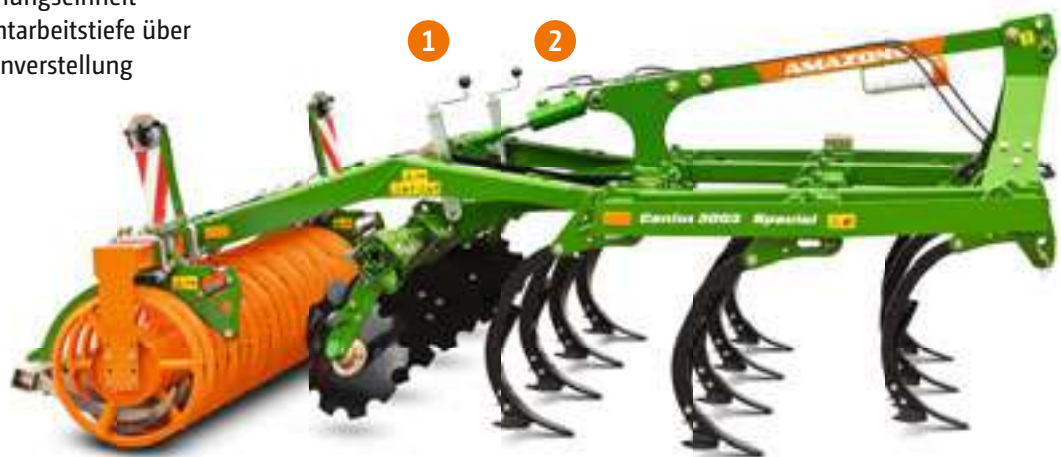
Cenius Special: C-Mix-Zinken mit Scherbolzen-Überlastsicherung und Winkelprofilwalze
