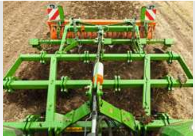
3-balkiger Rahmenaufbau des Cenius 3003 Special
